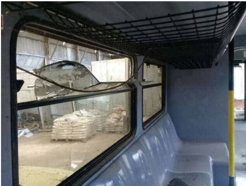
Foto 14: Interior – vidrio roto
